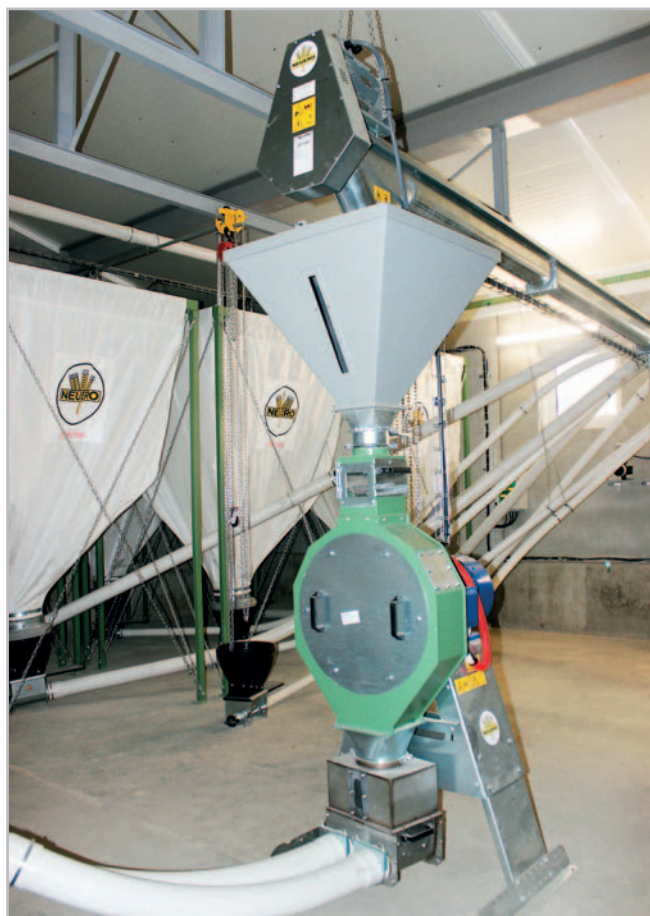
Našrotované základní komponenty krmné dávky se skladují ve vnitřních trevírových sílech Neuro o objemu 3,4 t (v pozadí)
