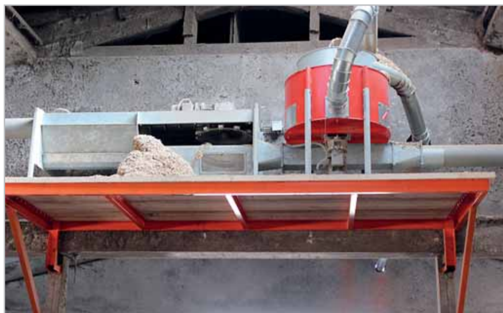
Předávací jednotka s vývěvou, která jemně nařezanou slámu zbavuje prachu a vzduchu
