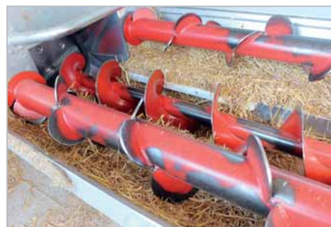
Základem rozdružovače jsou dva horizontální protiběžné pádlové válce a na dně umístěný šnekový dopravník o průměru 400 mm
