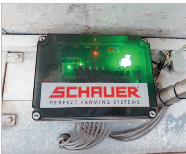
V každé z šesti sekcí s devíti porodními boxy ovládá krmění MamaDos jeden ovladač Schauer
